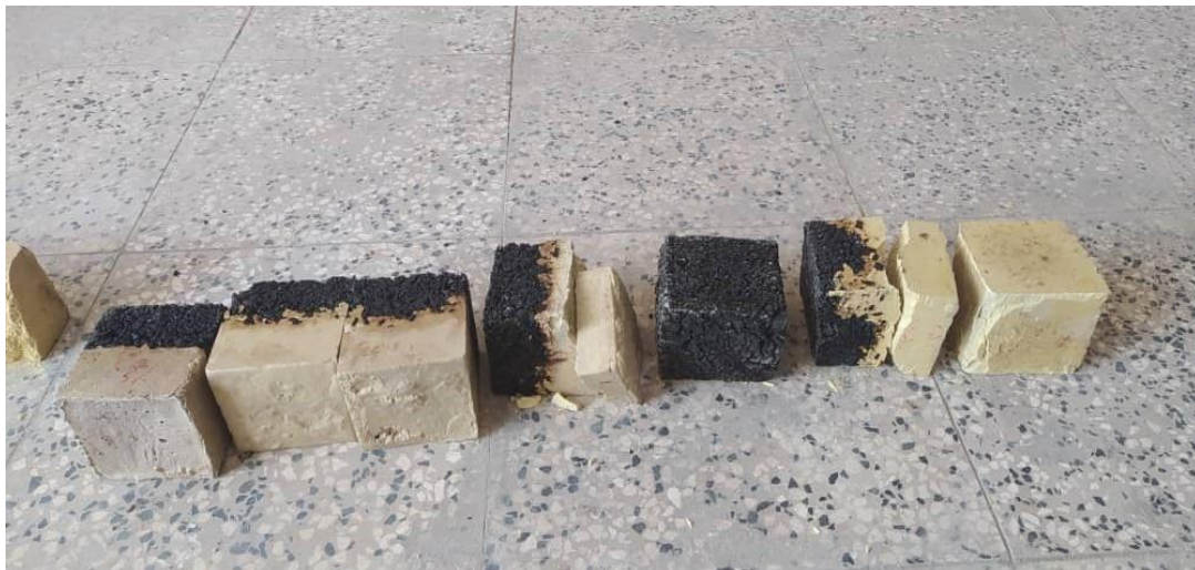
شکل ۶- نمونه‌های شکسته شده در آزمایش مقاومت فشاری
