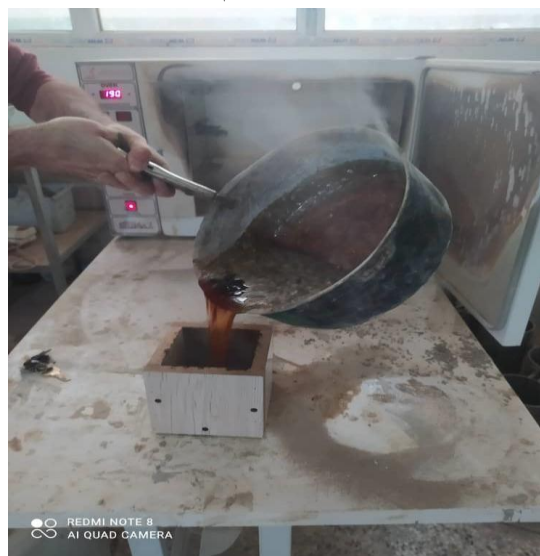
شکل ۱- نحوه ریختن گوگرد درون قالب
