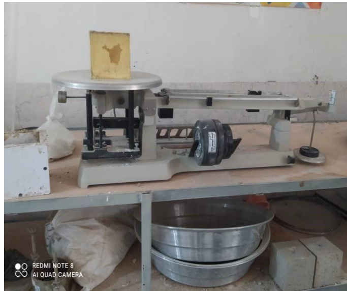
شکل ۲- وزن کردن نمونه گوگرد
