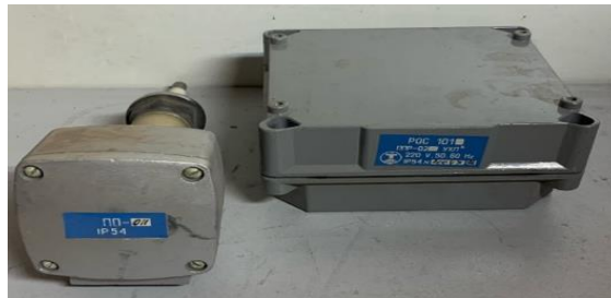
شکل ۴- ترانسیمتر روش خازنی مدل روس ۱۰۱
