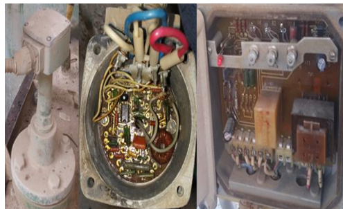
شکل ۷- ترانس미터 روش خازنی
