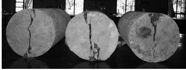
شکل ۹- حالت شکست شکافتن بتن زباله الکترونیکی خطرناک پس از بارگذاری نهایی
