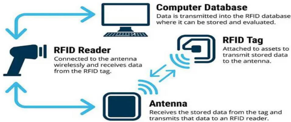
شکل ۳- سیستم امنیتی مبتنی بر RFID
