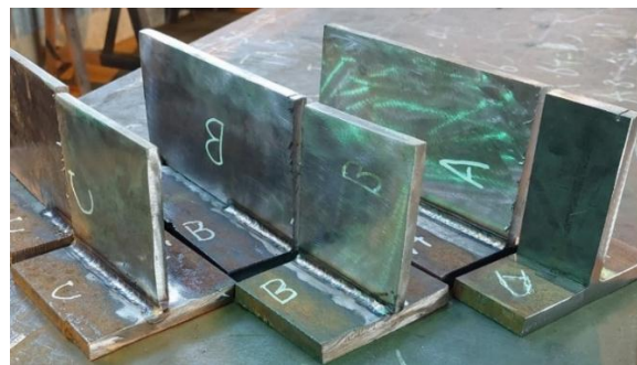
شکل ۶- نمونه های جوش داده با اتصال T شکل و برش داده شده جهت ارسال به آزمایشگاه مواد
