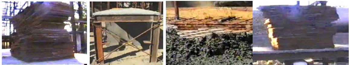
شکل ۹- اعمال بار نمایشی بر روی یک نمونه دال ساخته شده از سامانه بسیار سبک و عایق مورد نظر به ضخامت شش سانتیمتر و فاقد میلگردهای حمایتی، با قرار دهی وزنه های متعدد فولادی
