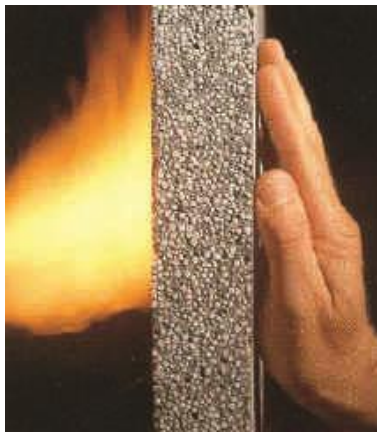
شکل ۱- نمونه ای از بتنهای سبک EPS از نوع معمول و نمایش عایق حرارت بودن آن و مقاومتش در برابر آتش (بر گرفته از سایت اینترنتی "B-Lite Aggregate")
