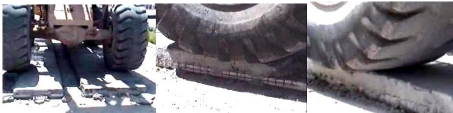
شکل ۳- اعمال نمایشی بار بر روی نمونه ای از قطعه مورد نظر
