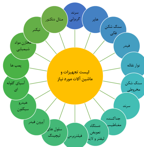
شکل ۱۷ - نمونه ای از لیست تجهیزات و ماشین آلات مورد نیاز در یک واحد فرآوری طلا
