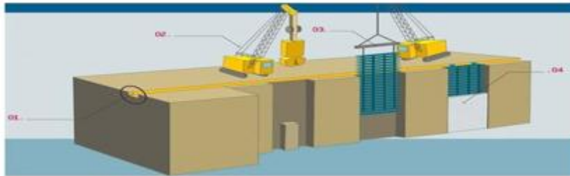
شکل ۱- مراحل ساخت دیوار دیافراگمی
