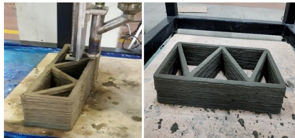
شکل ۵- نمونه هایی از پرینت تهیه شده از دیوار مجوف
