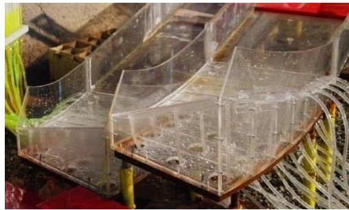
شکل ۱- مدل هیدرولیکی پرتاب کننده‌های جامی مرکب (شکل سمت راست) به همراه مشخصات هندسی آنها (شکل سمت چپ)
