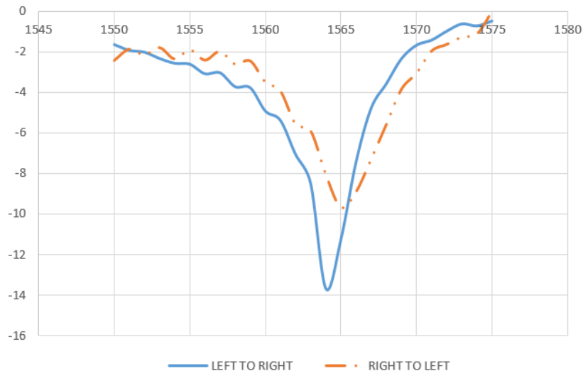
شکل ۵- نمودار طیف عبوری از ساختار با شدت 6/6 \text{ KW}/\mu\text{m}^2 Error! No text of specified style in document.
